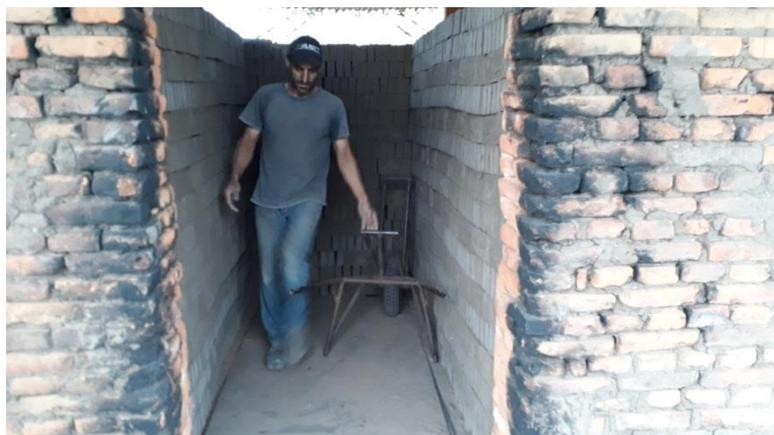
Para quemar los ladrillos el material que se utiliza como combustible para los hornos es principalmente la leña de eucalipto o pino, que es comprada y abastecida a través de aserraderos o leñeros. Para cada horneada se consumen unas seis toneladas de leña.
