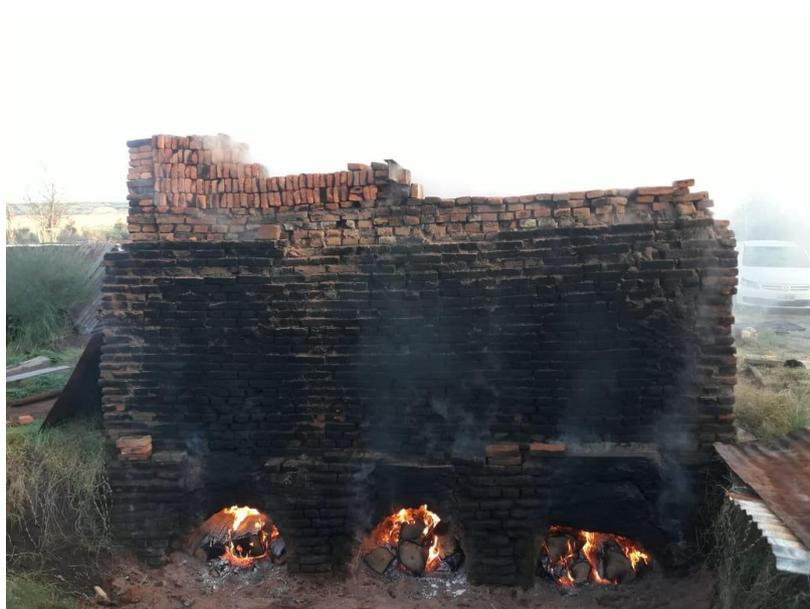
Una vez horneados, los ladrillos quedan apilados hasta que se comercialicen y se distribuyan. Se clasifican en primera, segunda, selección o vista, dependiendo de la calidad y grado de cocción. En cada horneada se obtienen unos 20.000 ladrillos, equivalentes a la construcción de una casa tipo para cuatro personas de unos setenta metros cuadrados.
