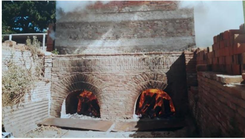
Pasadas las veinticuatro horas de encendido, comienza a descender gradualmente la temperatura, pero se mantiene con altas temperaturas durante tres o cuatro días, hasta que finalmente el horno se apaga y se obtienen los ladrillos cocidos.
